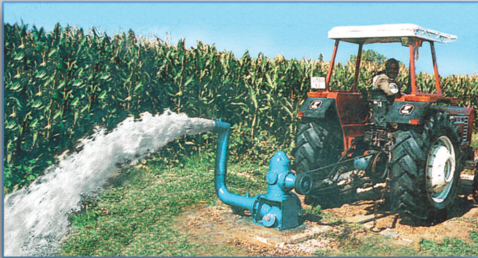
DİŞLİ BAŞLIK TAHRİKLİ KASNAK KAYIŞ BAĞLANTILI TİP GEAR BOY IN CONJUNCTION WITH TRACTOR-BELT DRIVE TYPE
