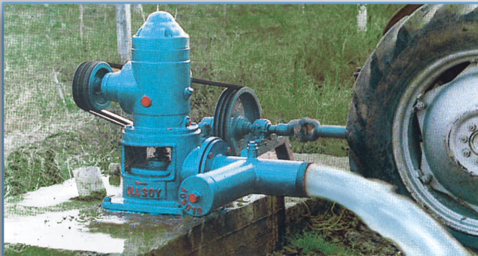
DİŞLİ BAŞLIK TAHRİKLİ KASNAK KAYIŞ ŞAFT BAĞLANTILI TİP GEAR BOY IN CONJUNCTION WITH CORDEN SHAFT TYPE
